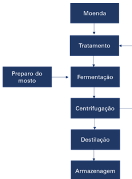
Figura 2: Fluxograma de Processo – Usina Bazan.
