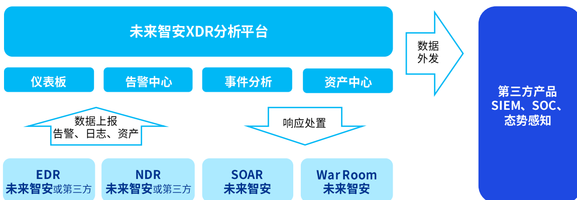
图42:未来智安XDR扩展威胁检测响应系统架构
