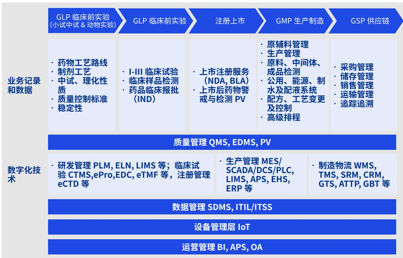
图：GxP 与业务流程、数据及数字化技术的关系
