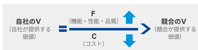
図表1|バリューエンジニアリング(VE)の概念式
