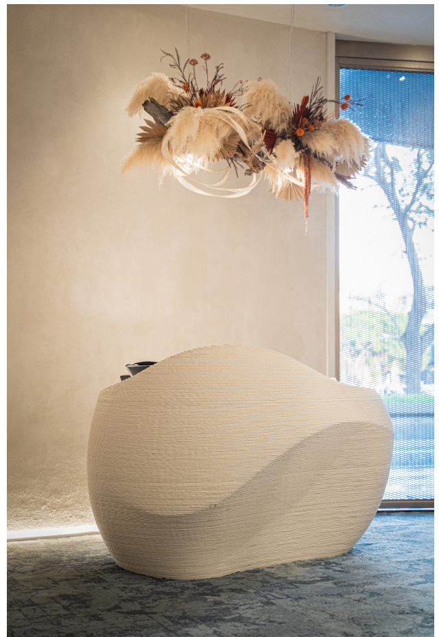
圖3 一踏入「Thomas Chien 法式餐廳」即見以中鋼爐石加上蚵殼粉，並採3D列印手法製作，宛如藝術裝置的接待櫃台
